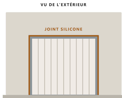
Figure 10 — Vu de l'extérieur : le joint silicone entre le cadre et le mur
