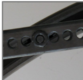
Figure 25 — Le trou repéré, au centre de la rainure du cintre
