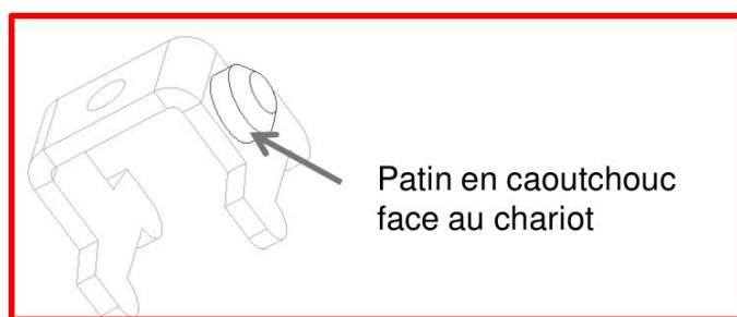
Figure 28 – Le patin en caoutchouc de l'arrêt de fin de course se tourne vers le chariot
