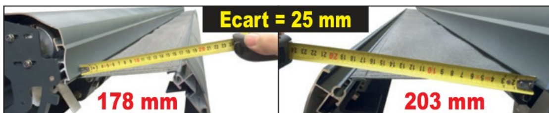
Figure 19 — La mesure de l'écart : 178 mm d'un côté, 203 mm de l'autre, soit 25 mm d'écart
