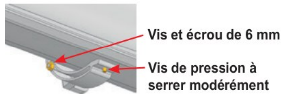
Figure 14 — Le blocage de la pièce en arc de cercle du support intermédiaire
