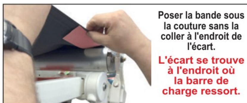
Figure 20 — La bande de calage se glisse sous la couture, sans la coller, à l'endroit de l'écart
