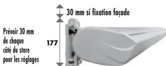
Figure 2 – Le coffre vu de profil : 177 mm de haut, 30 mm de vide au-dessus en pose de face, 30 mm de chaque côté du store pour les réglages
