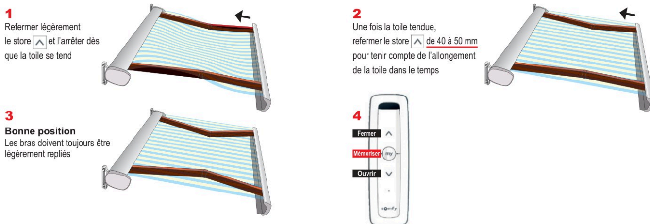
Figure 17 – Le réglage de la fin de course basse, en quatre étapes
