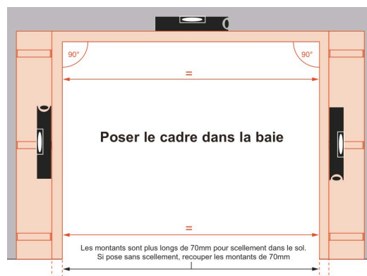
Figure 9 – Pose en tunnel : le cadre dans la baie, angles à 90°, même largeur en haut et en bas
