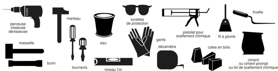
Figure 3 — L'outillage recommandé pour poser une porte de garage battante sur gonds
