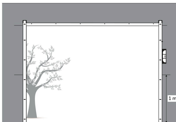
Figure 11 – Le second montant réglé au niveau sur son repère à 1 m
