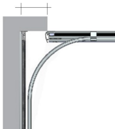
Figure 11 — Vue de dessus, côté refoulement : le rail prend le virage dans l'angle du garage
