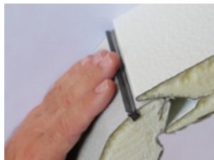
Figure 3 – Un panneau isolé de 40 mm vu en coupe : la mousse isolante entre les deux tôles
