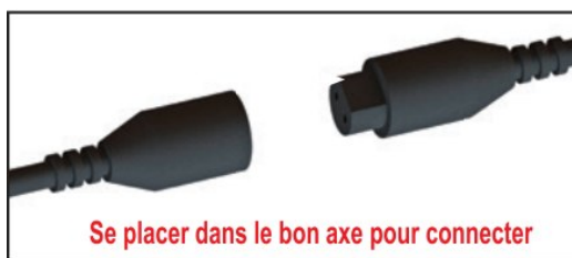
Figure 35 — Les deux connecteurs se présentent bien dans l'axe
