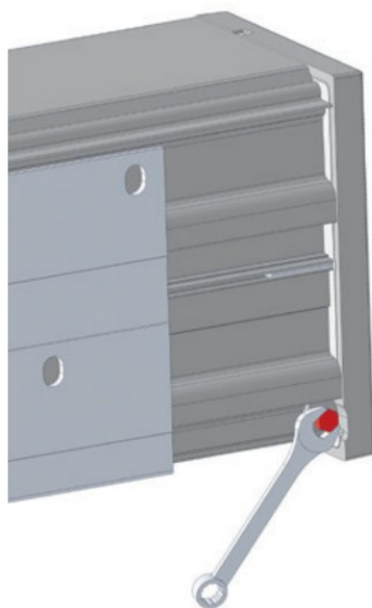
Figure 25 — La vis M6 à l'arrière du coffre, serrée à la clé plate de 10
