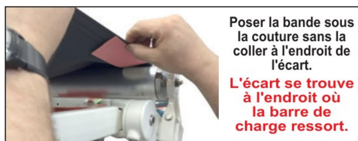
Figure 32 — La bande de calage se glisse sous la couture, sans la coller, à l'endroit de l'écart
