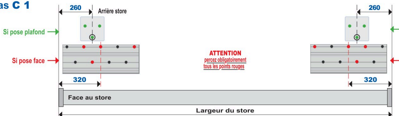
Figure 6 – Cas C1 : sur façade, axe des grands supports à 320 mm de chaque bout ; au plafond, équerres à 260 mm
