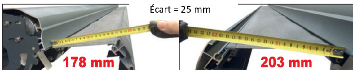
Figure 31 – La mesure de l'écart : 178 mm d'un côté, 203 mm de l'autre, soit 25 mm d'écart
