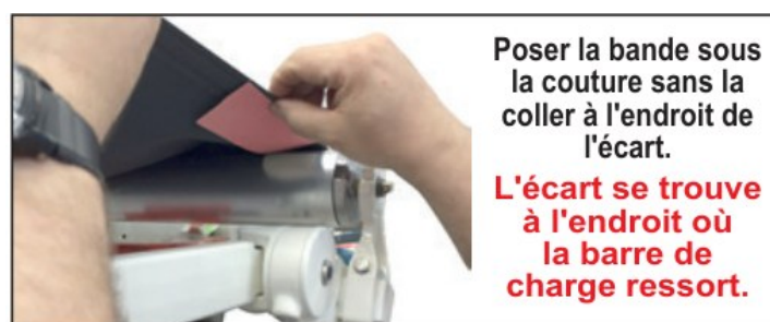
Figure 62 — La bande de calage se glisse sous la couture, sans la coller, à l'endroit de l'écart
