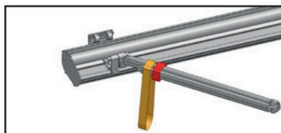
Figure 51 — Le manchon de sécurité, à ne pas enlever avant d'avoir posé la sangle ; la sangle en place ; le bras entrouvert, retenu par la sangle
