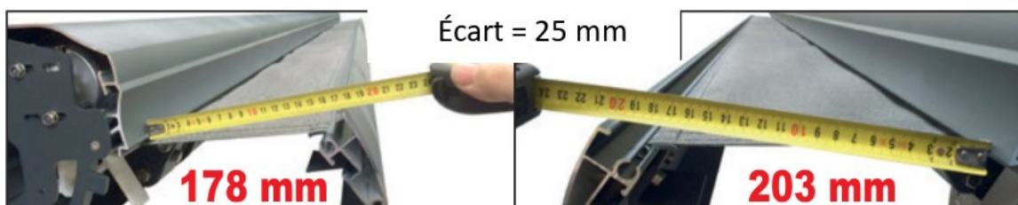
Figure 61 — La mesure de l'écart : 178 mm d'un côté, 203 mm de l'autre, soit 25 mm d'écart
