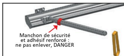
Figure 51 — Le manchon de sécurité, à ne pas enlever avant d'avoir posé la sangle ; la sangle en place ; le bras entrouvert, retenu par la sangle
