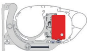
Figure 66 — Le boîtier (en rouge) posé dans le coffre, vu de profil
