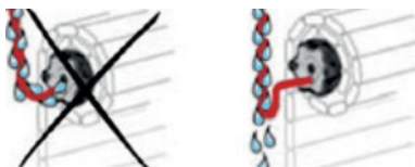
Figure 16 — À gauche, ce qu'il ne faut pas faire ; à droite, la boucle qui arrête l'eau
