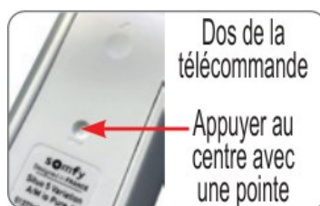
Figure 22 — La touche de programmation, au dos de la télécommande
