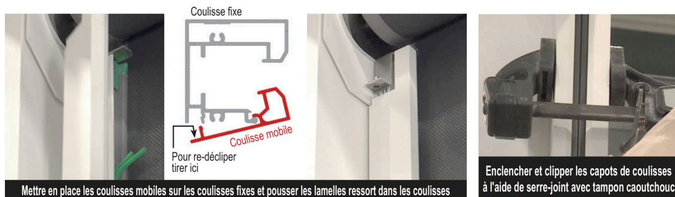
Figure 20 – La coulisse mobile (en rouge) se clippe sur la coulisse fixe, au serre-joint
