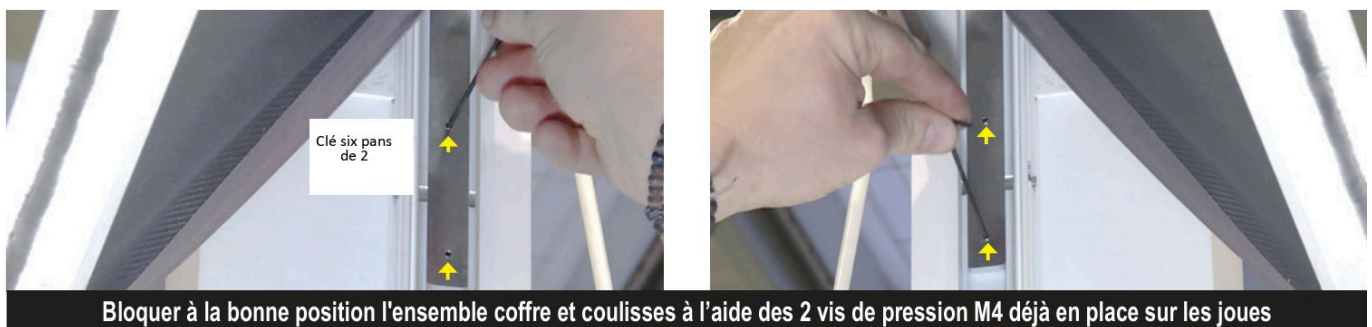
Figure 7 — Les 2 vis de pression M4 de la joue (flèches jaunes), à serrer à la clé six pans de 2
