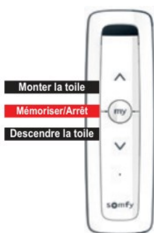
Figure 15 — Les trois touches de la télécommande Somfy : montée, « my » (mémoriser, arrêter), descente
