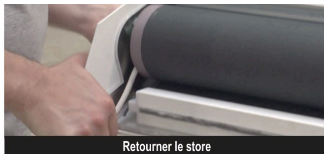
Figure 3 – Le capot à enlever, puis le store à retourner
