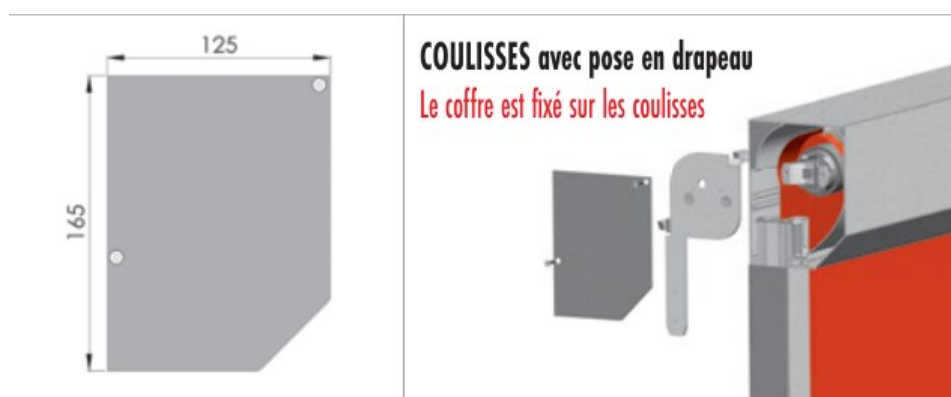
Figure 1 – La joue du coffre, 125 × 165 mm, et le coffre fixé sur ses coulisses
