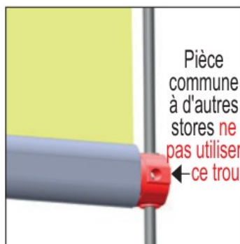
Figure 27 — L'embout (en rouge) enfilé sur le conducteur ; le trou à ne pas utiliser
