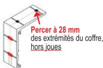
Figure 11 — Les trous de l'équerre, à 28 mm des extrémités du coffre, hors joues
