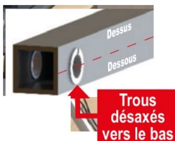
Figure 23 – La barre vue en bout : les trous sont désaxés vers le bas
