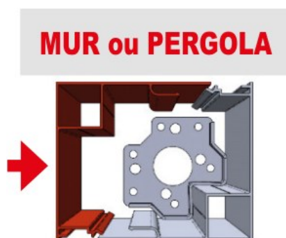
Figure 38 — Poteau contre un mur ou une autre pergola : le capot se clippe dans un sens particulier
