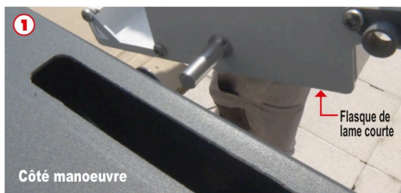
Figure 21 – L'axe côté manoeuvre s'engage à fond pour pouvoir insérer l'axe opposé
