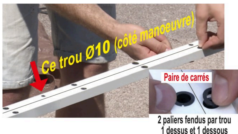
Figure 22 – Les paliers fendus sur la paire de barres ; le trou de Ø 10 est du côté de la manoeuvre
