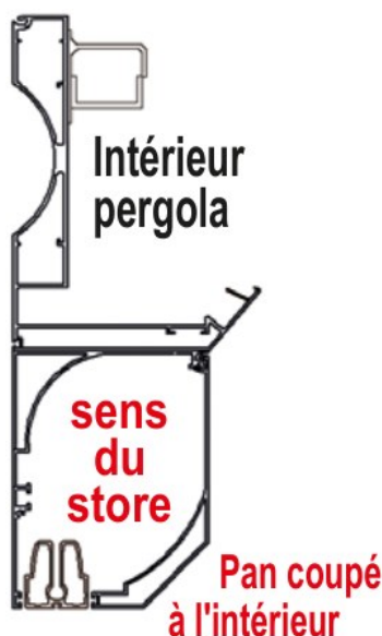
Figure 59 — Le sens du store : pan coupé à l'intérieur de la pergola
