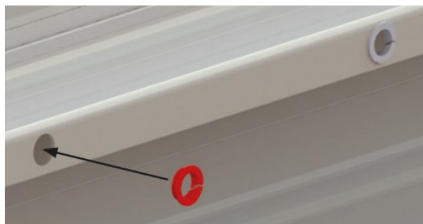
Figure 14 — Un palier fendu dans chaque trou du support de lames
