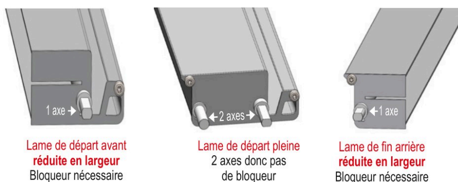
Figure 17 — lame de départ réduite (1 axe, bloqueur), lame pleine (2 axes, pas de bloqueur), lame de fin réduite
