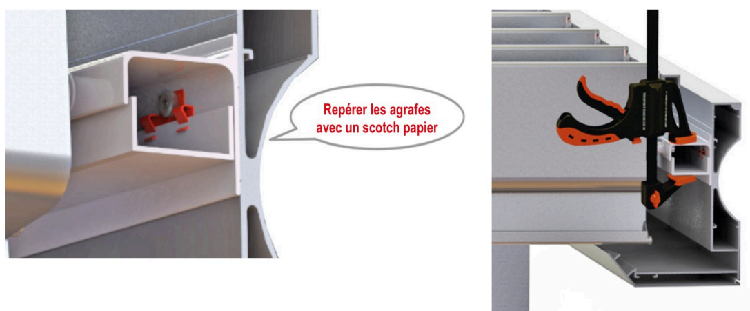
Figure 54 — Les agrafes sous le support de lames, et le clipage de la goulotte au serre-joint
