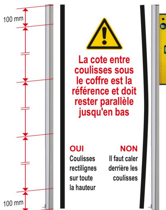
Figure 66 – Les 4 vis sur la hauteur, à 100 mm du haut et du bas ; des coulisses rectilignes
