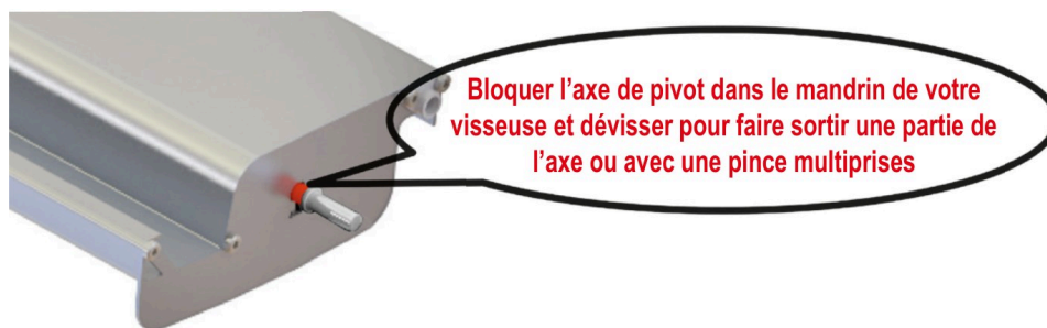
Figure 46 — L'axe de pivot se dévisse pour rattraper le jeu : 8 mm maxi
