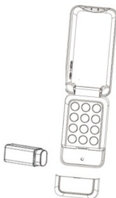
Figure 2 — Le clavier ouvert, la pile 9 V et le cache du bas retirés
